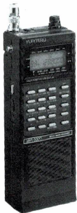
MVT 5000 pocket; MVT 6000 basis/mobiel: 25-550+800-1300 Mhz met ned. handleiding
